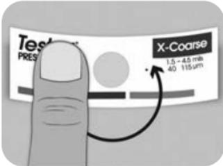
3. 将复制胶带贴在表面上。在复制泡沫周围轻按胶带的背面，确保在抛光过程中胶带保持在位。
