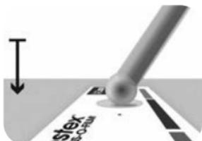
٤ب. إذا كنت تستخدم أداة الصقل الكلاسيكية، امسك الأداة كما تمسك قلمًا، واضغط ضغطًا مت\_sqًبا باستخدام الطرف الكروي للأداة، مع الحرص على عدم الضغط بقوة شديدة؛ حيث إن الضغط الزائد قد يؤدي إلى قياسات غير دقيقة.
