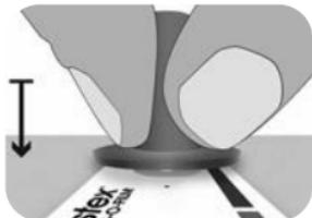
٤. للسطح المسطحة أو المحدبة: استخدم أداة الصقل عالية الدقة من تستكس، اضغط الكرة الموجدة في الأداة على رغوة الاستساخ بشكل كافٍ حتى تستقر القاعدة المسطحة على الشريط. حرك كرة الأداة حول فتحة رغوة الاستساخ الدائرية.
