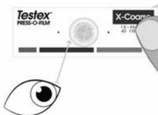
7. 检查复型膜以确保表面没有污染物（如灰尘、碎片、残留的喷砂介质）。将复制品置于光源下，应能在泡沫被表面轮廓的峰值压缩的地方看到一致的光“点”。
