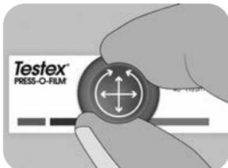
5. 연마 도구로 선형(x-y) 및 원형 동작(왼쪽 그림 참고)을 번갈아 하면서 전체 측정 영역이 균일한 회색 점(아래 그림 참고)들이 될 때까지 복제 품을 완전히 연마합니다.
